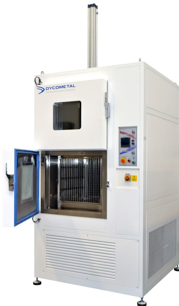
Equipamiento útil para la realización de Ensayos sobre el posible deterioro de la estructura de una muestra debido a súbitos cambios de temperatura. Estos Ensayos de Choque o Impacto Térmico establecidos de una manera cíclica, pueden ocasionar dilataciones, deformaciones o incluso ruptura sobre la estructura de la muestra, fallos eléctricos en su conexionado o diversas alteraciones en sus propiedades físico-químicas.
